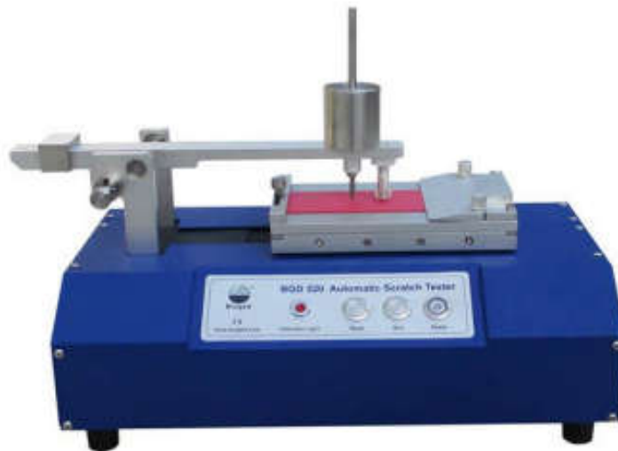
Figure 2 Thiết bị sử dụng áp lực khác nhau để xác định lực cần thiết để các định độ cứng bề mặt.
