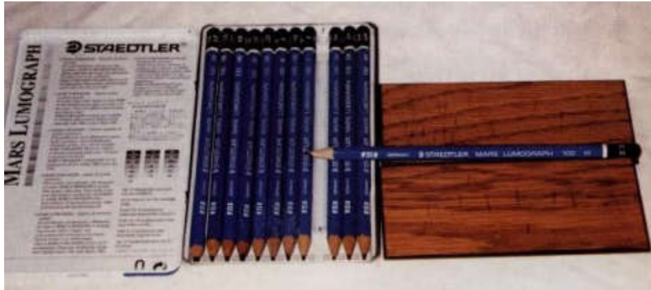
Figure 3 Một tập hợp các bút chì thử được hiệu chuẩn dùng để đo Độ cứng của bút chì
